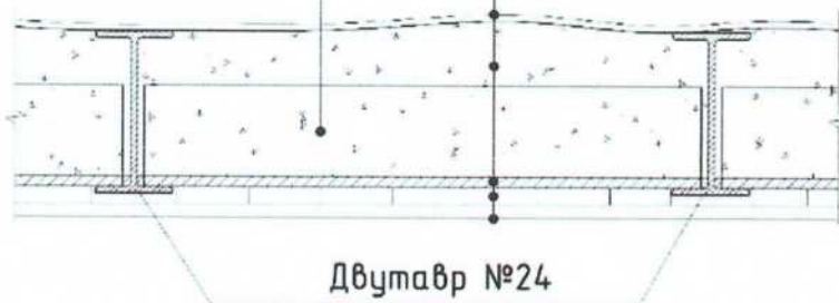
Рисунок 15. Конструктивное решение перекрытия 2-го этажа в месте вскрытия №2 и №3
